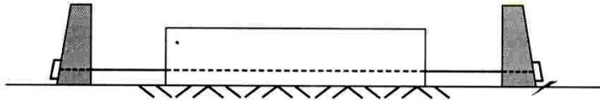
(ข) หล่อคอนกรีตและทำการบ่ม
