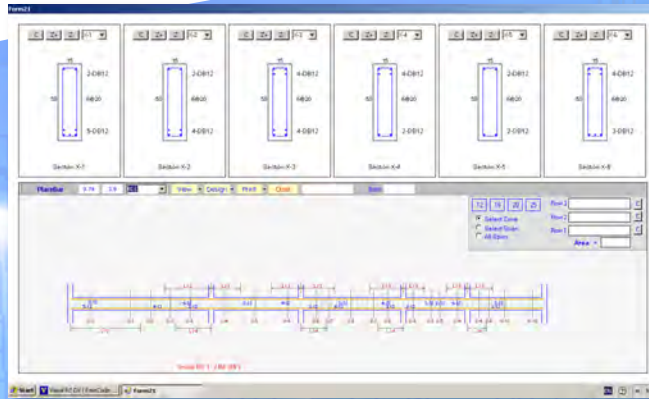
▲ การออกแบบรายละเอียดเหล็กเสริมคาน
