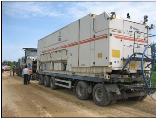
รูปที่ 3-8 การผสมสารผสมเพิ่มแบบ Slurry Mixed (WIRTGEN)
