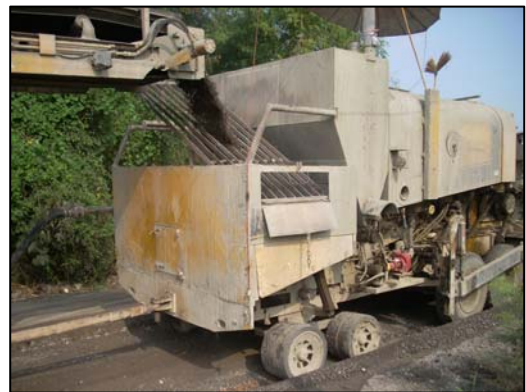
รูปที่ 3-9 การผสมสารผสมเพิ่มแบบ Dry Mixed (MIDLAND)
