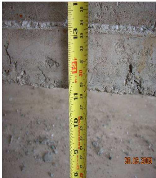
รูปที่ 16 วัดระยะการโก่งตัวสูงสุด “หลังรับน้ำหนัก”
