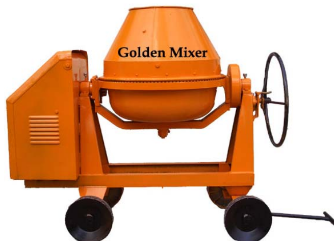
รูปที่ 2.14 โม่ผสมคอนกรีต
