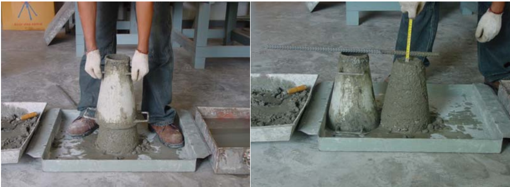
รูปที่ 1.45 ขั้นตอนการทดสอบการยุบตัวของคอนกรีต ที่มา: www.cte.kmutt.ac.th
