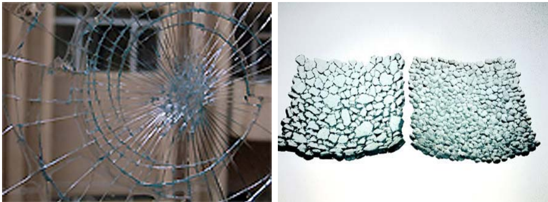
รูปที่ 1.145 กระจกนิรภัยเทมเปอร์ ที่มา: www.hondajazz-club.com
