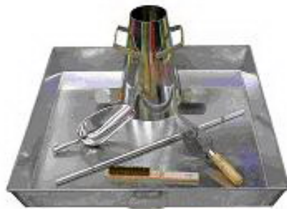
รูปที่ 1.44 เครื่องมือทดสอบการยุบตัวของคอนกรีต
