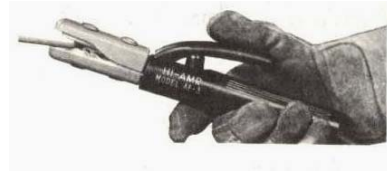
รูปคีมจับลวดเชื่อมมีฉนวนหุ้มตลอด
