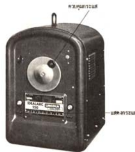
เครื่องเชื่อมกระแสสลับแบบหม้อแปลงที่ควบคุมกระแสต่อเนื่องได้
