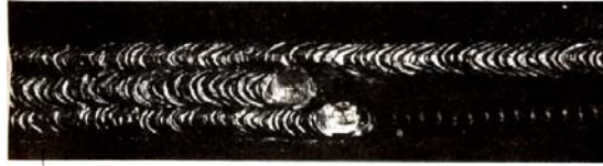
แนวเชื่อมเส้นขนานทำเนื้อสีระยะด้วย DCRP หรือ A.C.
