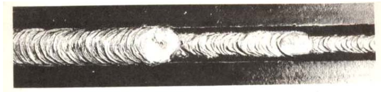
แสดงแนวเชื่อมต่อชนบทกร่องตัว V ทำราบด้วยลวดเชื่อม DCRP หรือ A.C.
