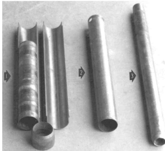
รูปที่ 1.22 กระบอกเก็บดินตัวอย่างแบบผนังบางและแบบผ่าซีก
