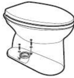
รูปที่ 4.38 ตัวอย่างการยึด โถส้วมโดยใช้นอตยึด
