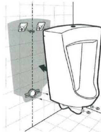
รูปที่ 4.84 ตัวอย่าง การติดตั้ง โถปัสสาวะชาย แบบชนิดท่อน้ำทิ้งในตัว
