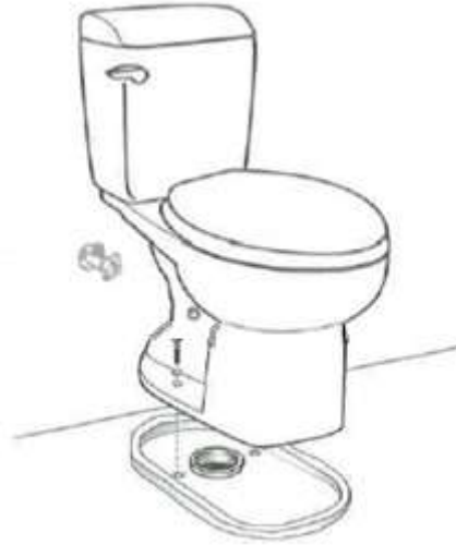
รูปที่ 4.41 ตัวอย่างทำเครื่องหมายแนวก่อปูนซีเมนต์ขาว และรูยึดโถส้วม
