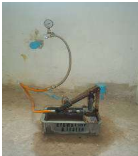
รูปที่ 5.3 ทำการติดตั้ง Pressure Gauge แล้วค่อยๆ เติมน้ำเข้าไปจนกว่าอากาศจะหมด
