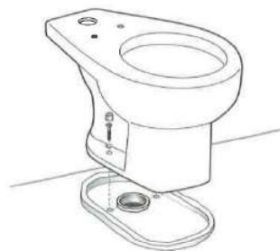
รูปที่ 4.51 ตัวอย่างการยึดโถส้วมโดยใช้นอตยึด
