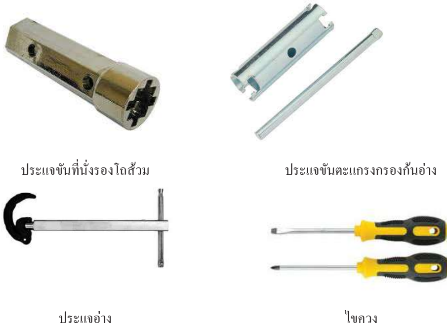
รูปที่ 3.19 เครื่องมือพิเศษที่ใช้สำหรับงานประกอบและติดตั้งเครื่องสุขภัณฑ์ชนิดต่างๆ
