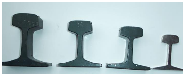
รูปที่ ๑.๒ (จากซ้ายไปขวา) รางขนาด ๑๐๐, ๘๐, ๗๐ และ ๕๐ ปอนด์ต่อหลา
