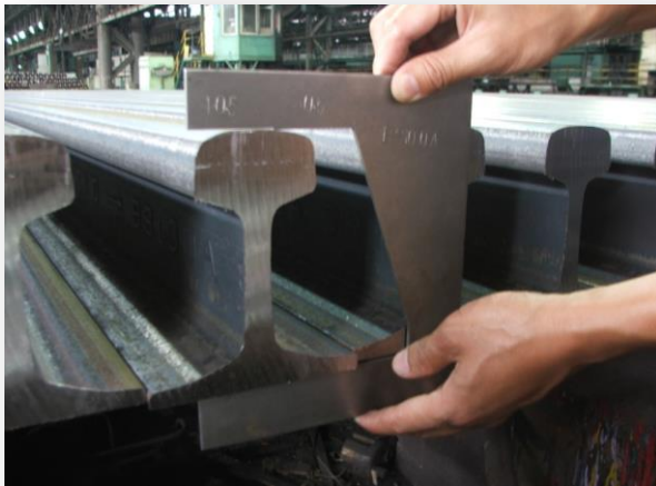
รูปที่ ๓.๗ ตรวจสอบความสูงของรางและความกว้างที่ฐานราง
