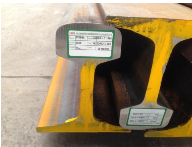
รูปที่ ๑.๖ หน้าตัดรางที่ทาสีและติดสติ๊กเกอร์แสดงรายละเอียดของรางเมื่อผลิตเสร็จ
