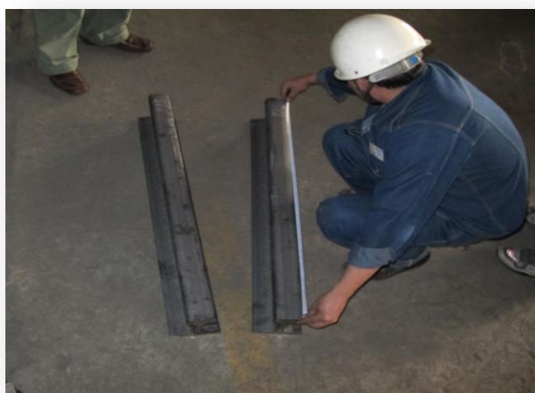
รูปที่ ๓.๑๐ การหาน้ำหนักแท้จริงของรางโดยการชั่งน้ำหนักขึ้นราง
