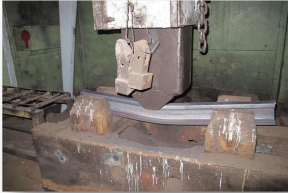
รูปที่ ๓.๓ ชิ้นรางที่ผ่านการรับน้ำหนักตกกระแทกและวัดค่าแอนตัว
