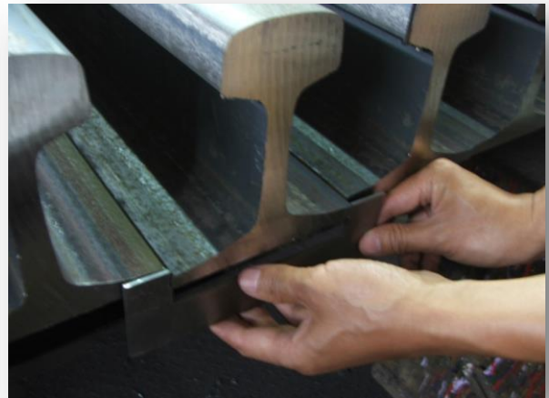
รูปที่ ๓.๗ ตรวจสอบความสูงของรางและความกว้างที่ฐานราง
