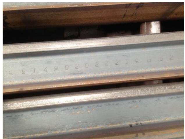
รูปที่ ๑.๕ การทำตราประทับเหล็กขณะร้อน
