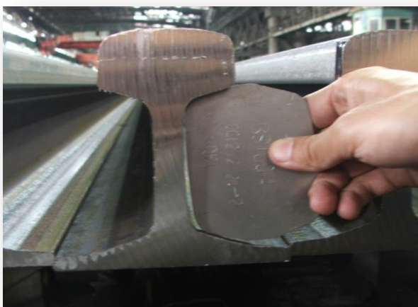
รูปที่ ๓.๙ ตรวจสอบระยะระหว่างผิวสัมผัสเหล็กประกบรางและความไม่สมมาตรของหน้าตัดราง
