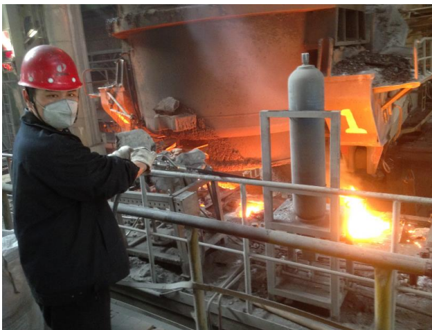
รูปที่ ๓.๒ การตรวจสอบปริมาณไฮโดรเจนตกค้างก่อนและหลังการผลิตราง
