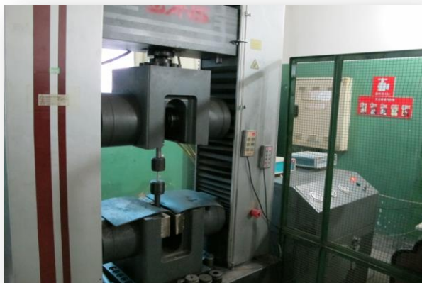
รูปที่ ๓.๔ การทดสอบความต้านทานแรงดึง
