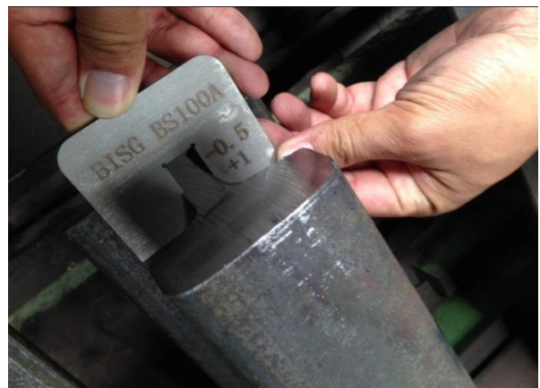
รูปที่ ๓.๘ ตรวจสอบความกว้างของหัวรางและความหนาของเอวราง
