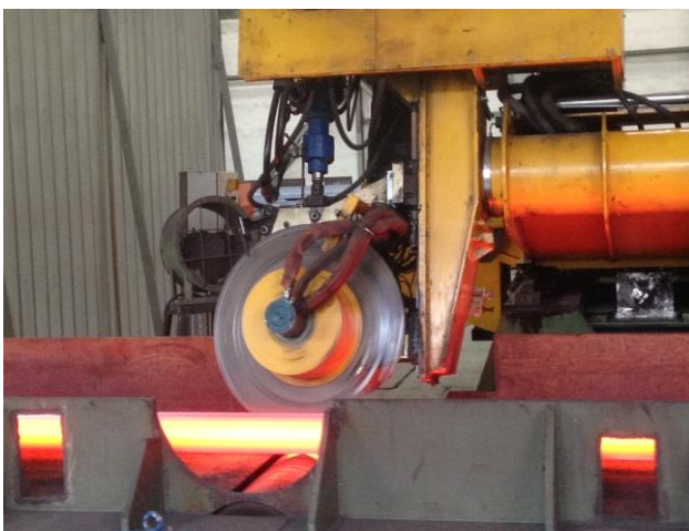
รูปที่ ๑.๕ การทำตราประทับเหล็กขณะร้อน
