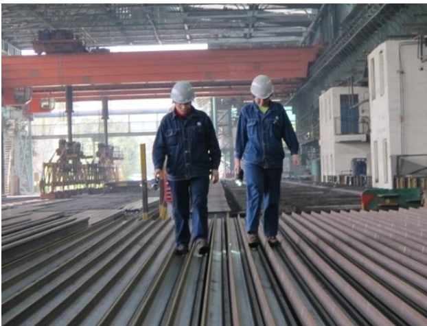
รูปที่ ๒.๑๑ การเดินตรวจรางด้วยตาเปล่าบนลานตรวจราง (Inspection Bed) และการตรวจมิติ
