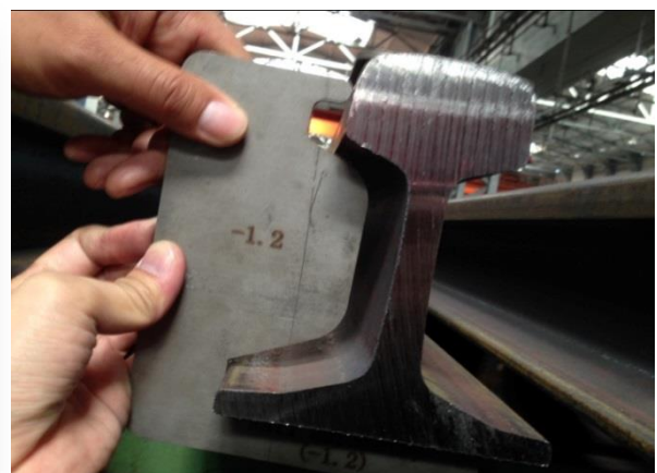
รูปที่ ๓.๙ ตรวจสอบระยะระหว่างผิวสัมผัสเหล็กประกบรางและความไม่สมมาตรของหน้าตัดราง
