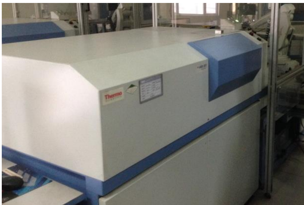
รูปที่ ๓.๑ การวิเคราะห์ส่วนผสมทางเคมีด้วยระบบอัตโนมัติ
