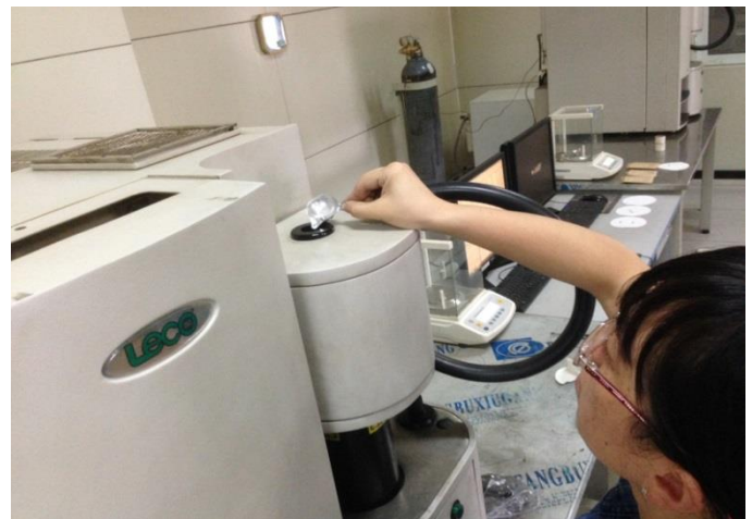
รูปที่ ๓.๒ การตรวจสอบปริมาณไฮโดรเจนตกค้างก่อนและหลังการผลิตราง
