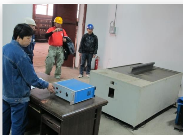
รูปที่ ๓.๑๐ การหาน้ำหนักแท้จริงของรางโดยการชั่งน้ำหนักขึ้นราง
