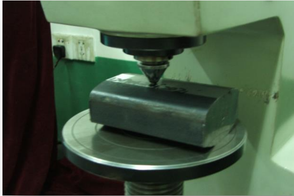
รูปที่ ๓.๕ การทดสอบความแข็งแรงแบบไพรเนลที่ผิวราง
