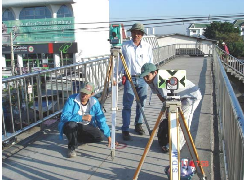
รูปที่ 2.1 การทำจุดอ้างอิงสำหรับการสำรวจและวางแนวด้วยระบบพิกัด
