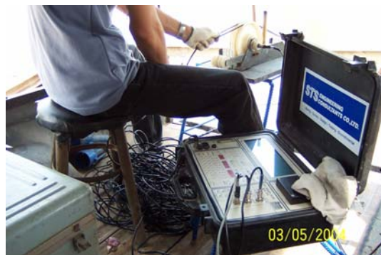
รูปที่ จ.5 เครื่องมือทดสอบ Sonic Logging Test
