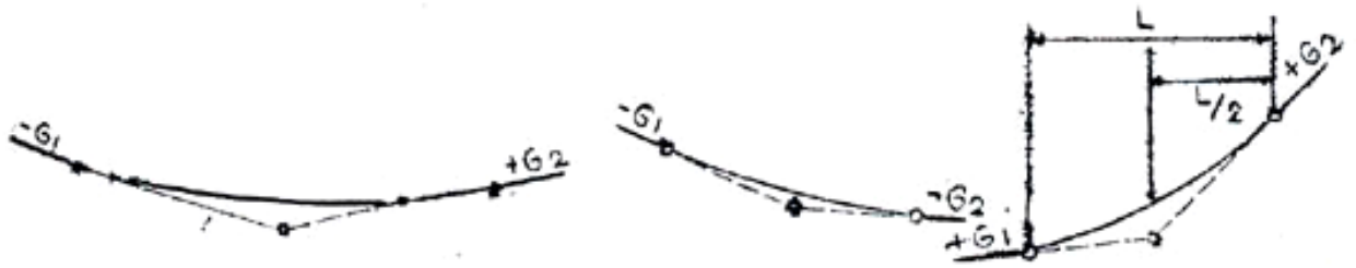
รูปที่ ก.16 โค้งทางโค้งหงาย (Sag Vertical Curve)
