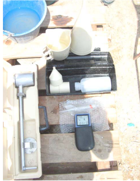
รูปที่ 5.8 ชุดทดสอบคุณสมบัติ ของเหลวพวยงเสถียรภาพหลุมเจาะ
