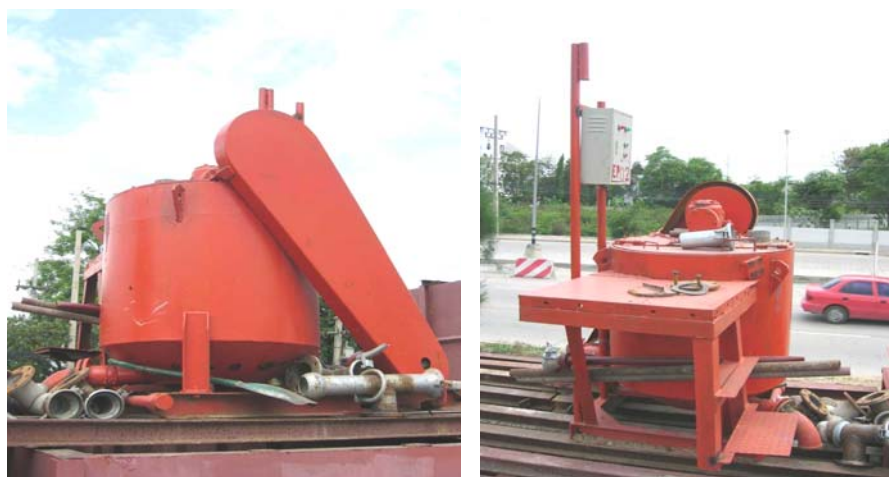
รูปที่ 5.3 เครื่องผสมของเหลวพยางเสถียรภาพหลุมเจาะ
