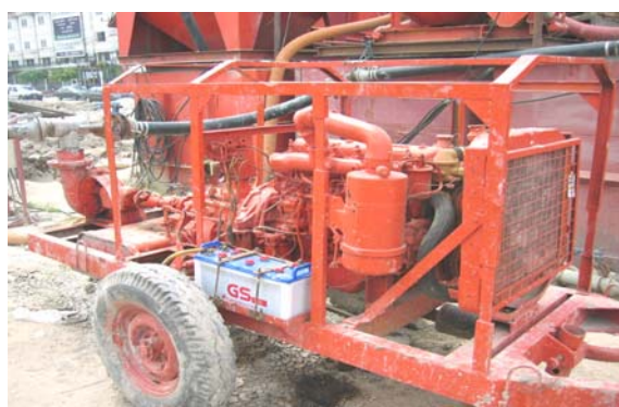
รูปที่ 5.5 เครื่องสูบของเหลวพยางเสถียรภาพเข้าไปในหลุมเจาะขนาดเส้นผ่านศูนย์กลางท่อ 4"
