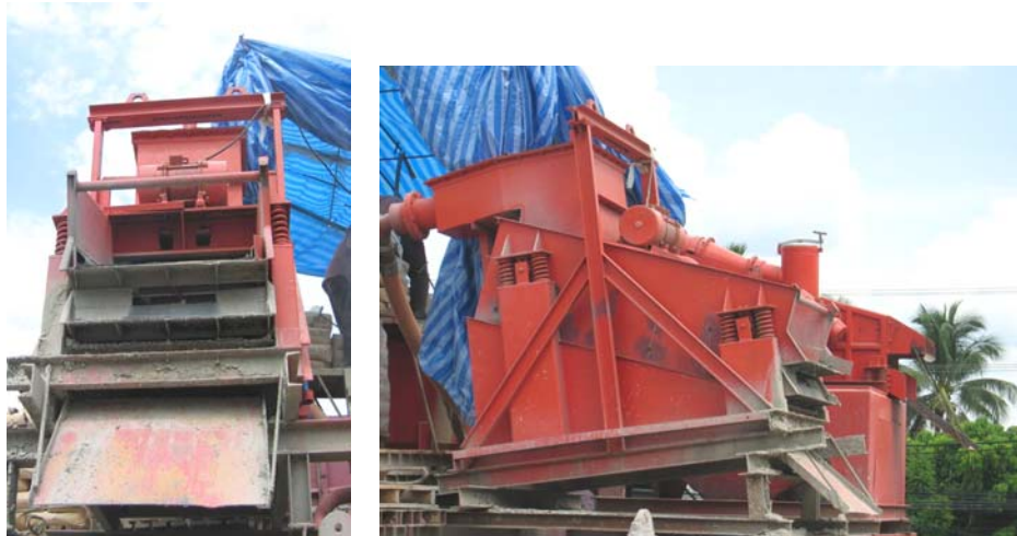
รูปที่ 5.2 เครื่องแยกตะกอนทรายออกจากของเหลวพยางเสถียรภาพหลุมเจาะ (Desander Unit)
