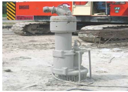
รูปที่ 5.4 เครื่องสูบของเหลวพยางเสถียรภาพออกจากหลุมเจาะขนาดเส้นผ่านศูนย์กลางท่อ 8"
