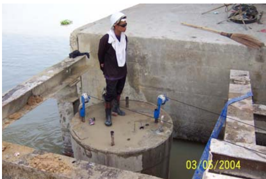
รูปที่ จ.4 การทดสอบความสมบูรณ์ของเสาเข็มเจาะ
