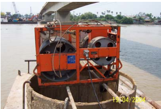
รูปที่ ๑.๘ การตรวจสอบสภาพผนังหลุมเจาะ (Drilling Monitor) โดยใช้เครื่องมือ KODEN
