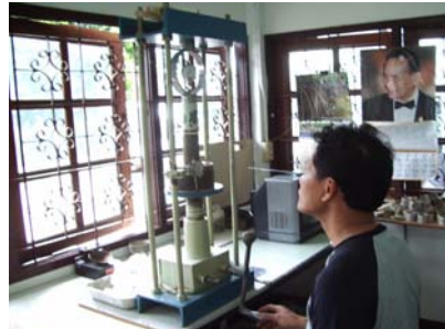
ภาพแสดงการทดสอบหาค่า Undrained Shear Strength
