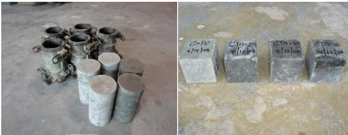
รูปที่ 1.1 ตัวอย่างทดสอบรูปทรงกระบอกและรูปทรงลูกบาศก์
