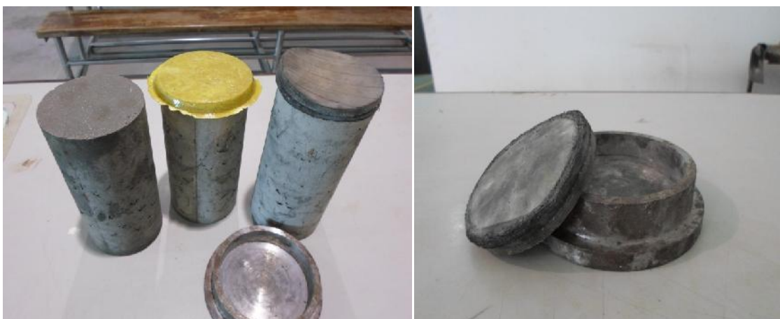
รูปที่ 1.4 ตัวอย่างทดสอบและแผ่นยางรองผิวทดสอบกำลังอัด
