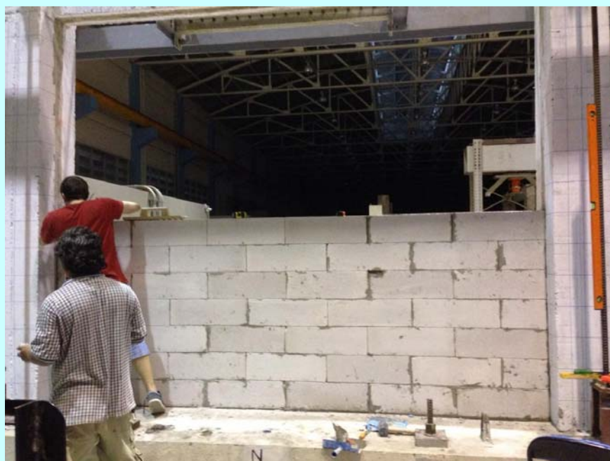
ผนังก่ออิฐมวลเบาในโครงเฟรมคอนกรีตเสริมเหล็ก (W2)
