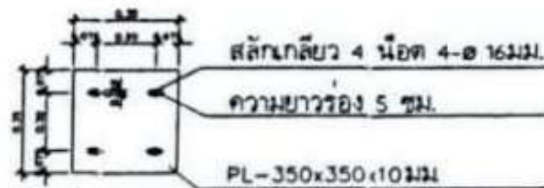
ขยายฐานรองรับแบบ Roller Support
