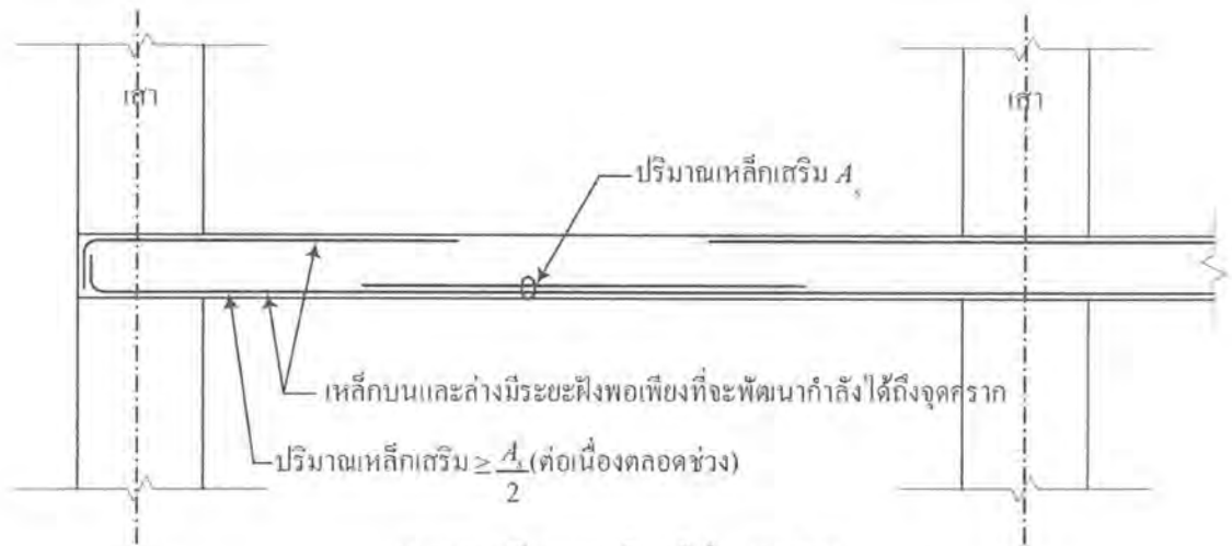
(ค) รายละเอียดการเสริมเหล็กในแถบกลาง
