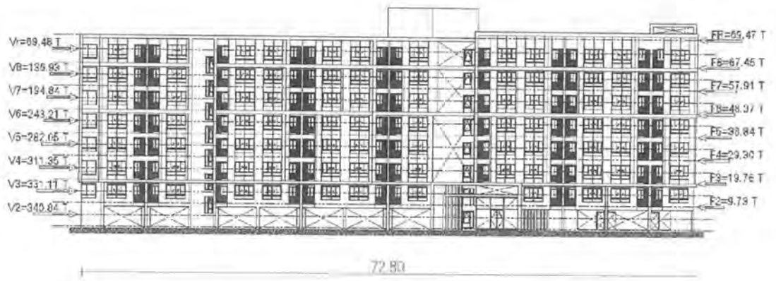
รูปที่ 3 การกระจายแรงกระทำค้ำข้างอาคารในแนวแกน X
