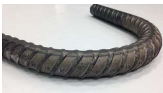
รูปที่ 2 การดัดโค้งของเหล็กข้ออ้อย
