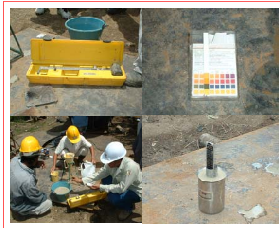
การควบคุมคุณสมบัติของสารละลายโพลีเมอร์ให้เป็นไปตามมาตรฐานที่กำหนด
