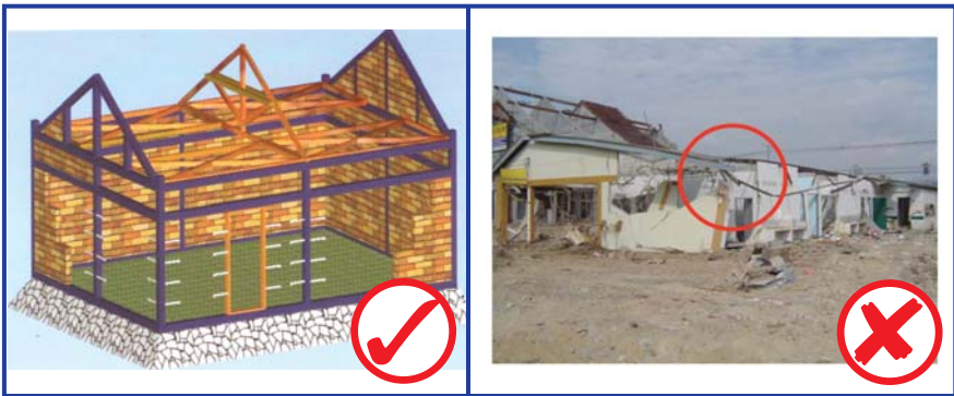
รูปที่ 7 (ก) ลักษณะอาคารที่มีการยึดโยงที่ระดับหัวเสาและคานคอดิน (UNDP, 2007)
