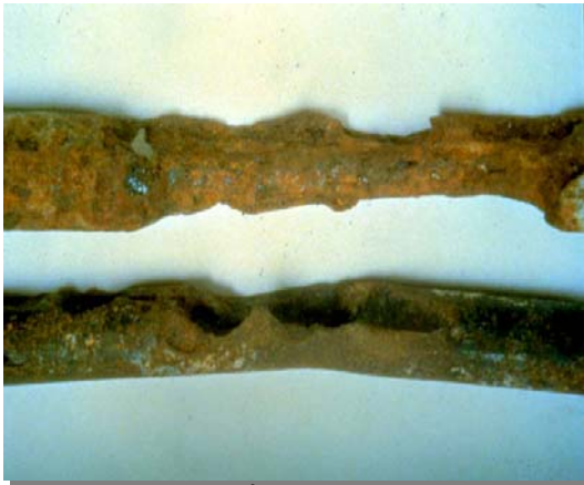
รูปที่ 1 แสดงการเป็นสนิมของเหล็กเสริมและการหลุดร่อนของคอนกรีต
