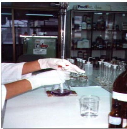
รูปที่ 3. การทดสอบ Chloride Content ในห้องปฏิบัติการ (ที่มา : ณัฐมนต์ และ จุลเศรษฐ์, 2545)
