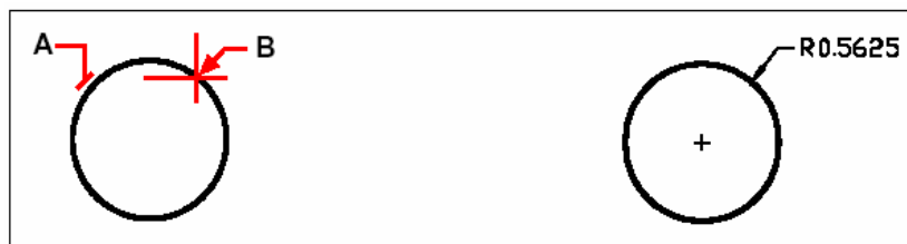
การบอกขนาดรัศมี เลือกไปที่วงกลมที่ตำแหน่ง A กำหนดจุดวางของเส้นบอกขนาดที่ตำแหน่ง B
