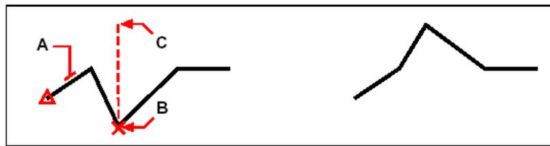
เลือกเส้น Polyline (ที่ตำแหน่ง A) ย้ายเครื่องหมาย X ไปยังจุดต่อเส้นที่ต้องการย้าย (ที่ตำแหน่ง B) และจากนั้นย้ายจุดต่อเส้นไปที่จุดใหม่ (ที่ตำแหน่ง C) ผลลัพธ์ที่ได้
