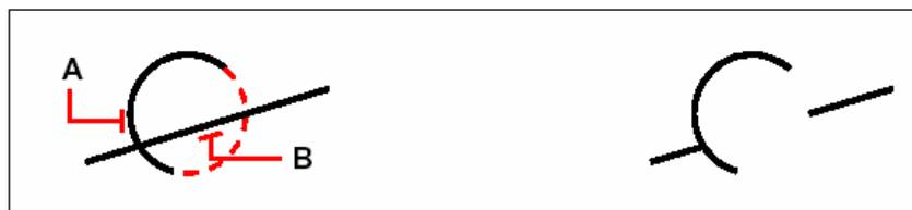
เลือกไปยังวัตถุที่เป็นตัวอ้างอิงสำหรับการตัด (ที่ตำแหน่ง A)
