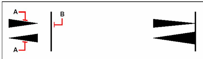
เลือกเส้น Polyline ที่เป็น Taper (ที่ตำแหน่ง A) และ Taper นั้นจะยังคงความเป็น Taper ไปเรื่อยๆ จนกว่าจะไปชนยังจุดหมาย (ที่ตำแหน่ง B) ผลลัพธ์ที่ได้
