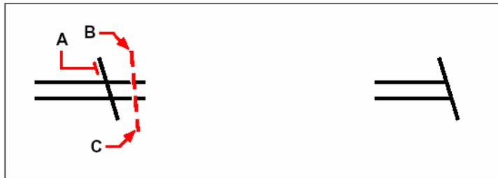
เลือกไปยังวัตถุที่เป็นตัวตัด (ที่ตำแหน่ง A) แล้วกำหนดจุดเริ่มต้นของการเลือกวัตถุ (ที่ตำแหน่ง B) กำหนดจุดที่สองของการเลือกวัตถุ (ที่ตำแหน่ง C) ผลลัพธ์ที่ได้
