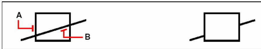
เลือกวัตถุที่เป็นตัวอ้างอิงสำหรับการตัด (ที่ตำแหน่ง A)
