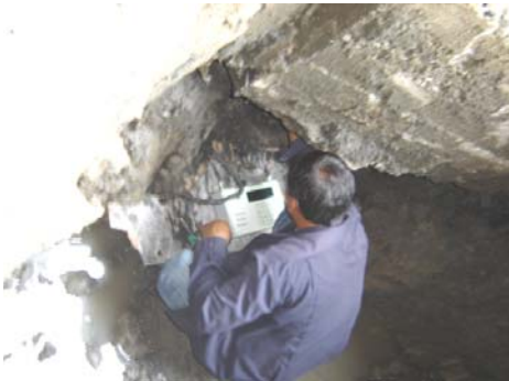
รูปที่3 ตรวจสอบเสาเข็มโดยParallel Seismic
